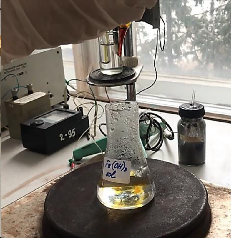
Рис. 1.2. Додавання розчину ферум(III) хлориду до дистильованої води, нагрітої до кипіння, при перемішуванні
